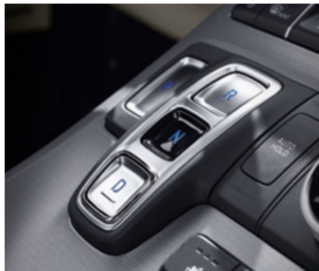
8-ступінчаста автоматична коробка передач з електронним перемиканням передач кнопкового типу
